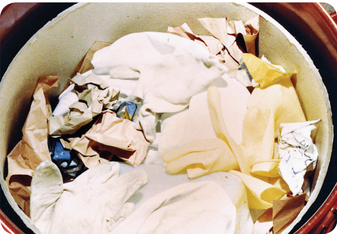
可压缩的低放射性废弃物包括，受到放射性污染的衣物、玻璃以及建筑材料。来源：（Sellafield公司）
